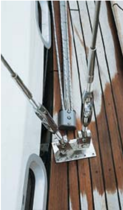
Püttinge: An diesen überdimensionierten Beschlägen lassen sich die Liebe zum Detail und der hohe Anspruch erkennen
