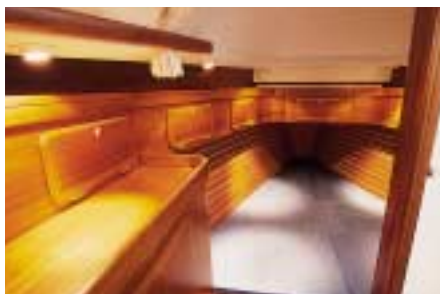
Aufwändig: Bei den Einbauten wurde möglichst auf durchgängige Maserung geachtet
