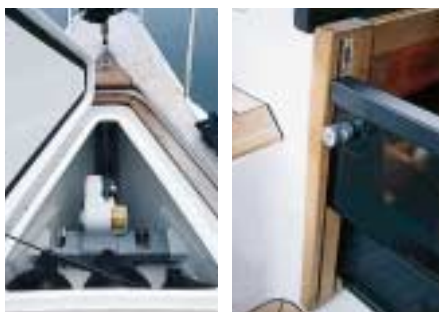
Praktisch: Winde und Anker unter Deck, Steckschotten sind Teil des Niedergangs
