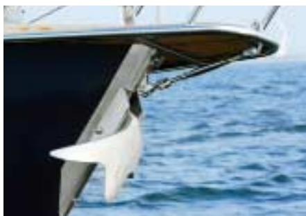
Integriert: Der Anker lagert unter der Bugplattform in einem Rumpfdurchbruch
