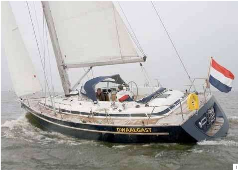
1 De schootlieren staan erg ver naar buiten. Vanuit het gangboord is de bediening ervan beter dan vanuit de kuip zelf.
