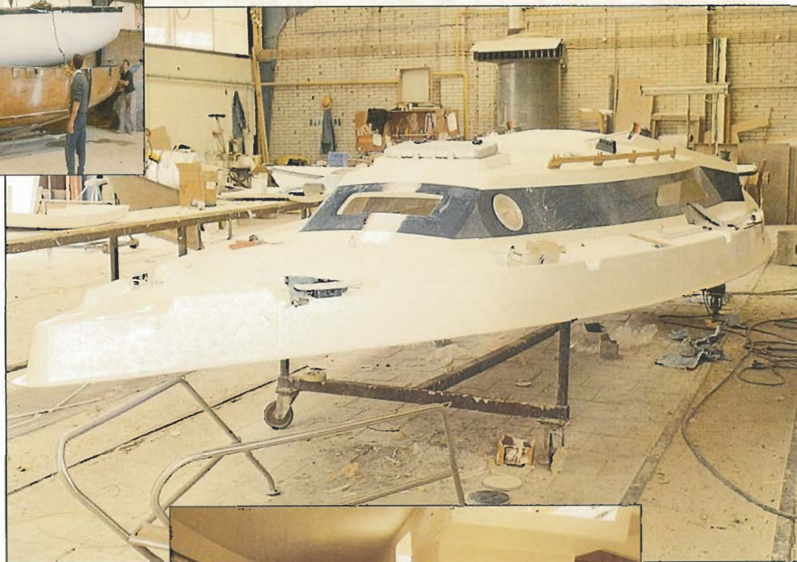
Een romp is klaar en komt uit de mal. Eerst wordt door middel van perslucht een soort van schrikreactie opgewekt, waarna met water de romp uit de mal wordt gedrukt. Foto rechts: wanneer een dek uit de mal is, wordt er eerst al het beslag op gemonteerd.
