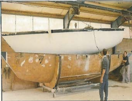
Een romp is klaar en komt uit de mal. Eerst wordt door middel van perslucht een soort van schrikreactie opgewekt, waarna met water de romp uit de mal wordt gedrukt. Foto rechts: wanneer een dek uit de mal is, wordt er eerst al het beslag op gemonteerd.
