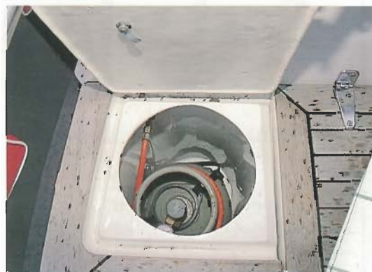
Das Gasfach im Cockpit: vorschriftsmäßiger Einbau nach Norm.
