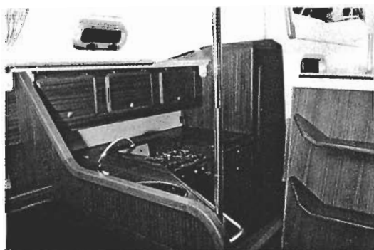
Dank mehrerer Handläufe und einer senkrechten Stütze läßt sich in dieser Pantry auch bei Seegang arbeiten.
