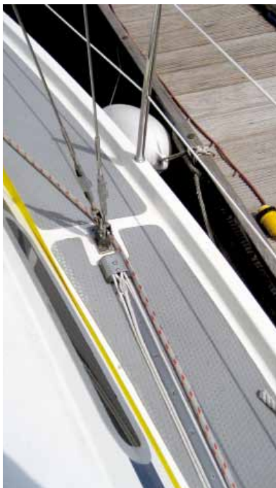
Auf späteren Exemplaren gehörten auch leinenverstellbare Holepunkte zum Standard.
