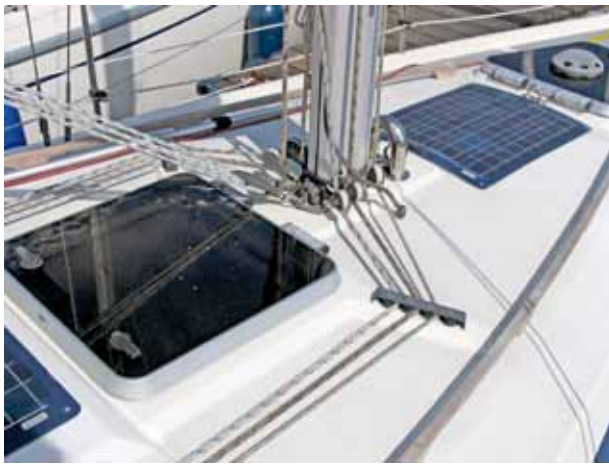
Große Gebo-Klappluken über Vorschiff und Salon sorgen für Licht und Luft unter Deck, alle Fallen und Reffleinen sind ab Werft nach achtern umgelenkt.
