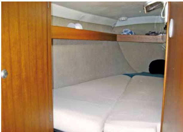
Platz für zwei. Die Achterkammer bietet eine vollwertige Doppelkoje, die lichte Höhe unter der Cockpitwanne beträgt 60 Zentimeter. Ein Klappfenster sorgt für Lüftung.
